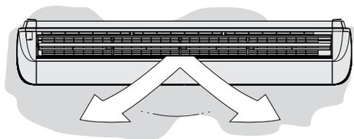
Regular manualmente os defletores verticais para alterar a direção do fluxo de ar para esquerda ou para direita, movendo as alavancas dos defletores (a posição destas poderá variar conforme o modelo).
