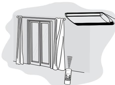
Se o receptor de sinal infravermelho na unidade interna for exposto diretamente aos raios solares, a unidade não funcionará adequadamente. Bloqueie a incidência dos raios solares até eliminar a exposição.
