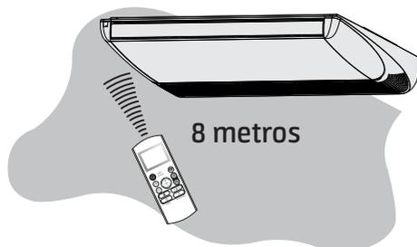
Posicionar o controle remoto de modo que os sinais enviados possam alcançar facilmente o receptor da unidade interna (a uma distância máxima de 8 metros).
