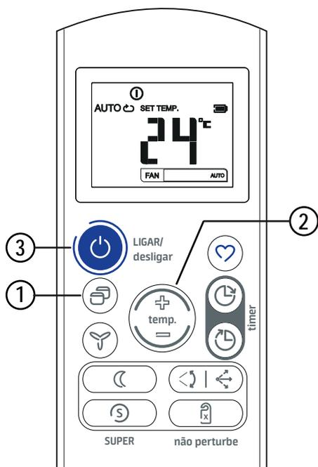
É importante lembrar que alguns parâmetros de funcionamento do equipamento irão ser fixos durante a operação no modo AUTOMÁTICO (AUTO) e será possível alterar apenas a temperatura desejada através do controle remoto. Selecionando o modo **auto** não é necessário regular a velocidade do ventilador pois esta será regulada automaticamente.
